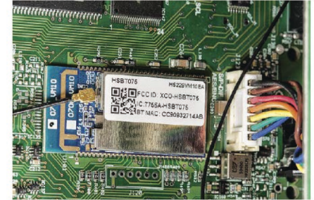
Obwody radiowe zostały zaekranowane z uwagi na swój "inwazyjny" charakter.
