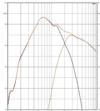
Rys. 3. Charakterystyki sekcji niskotonowej i średniotonowej.
