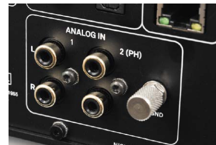
W ustawieniu początkowym obydwa wejścia analogowe są liniowe, ale jedno z nich możemy przełączyć w tryb phono (MM).
