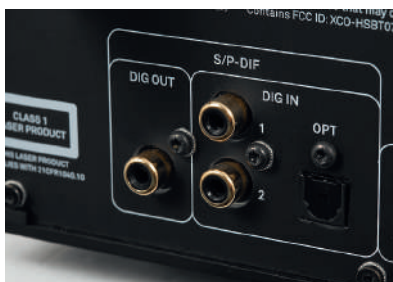
Oprócz wyjścia współosiowego są też wyjścia cyfrowe – elektryczne i optyczne.
