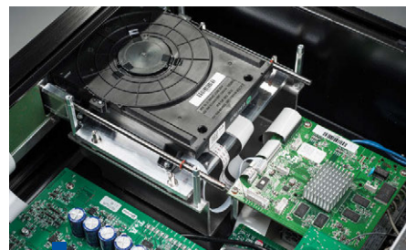
Mechanizm czytnika SACD normalnie jest przykryty aluminiowym ekranem widocznym na zdjęciu po lewej stronie.
